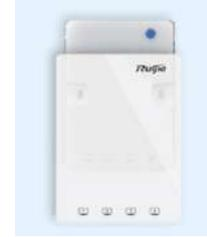
Iluminación de estado del dispositivo está cubierto por un plato
